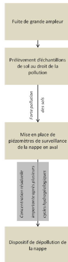
Figure 541 : Dispositifs de traitement d'une pollution accidentelle
