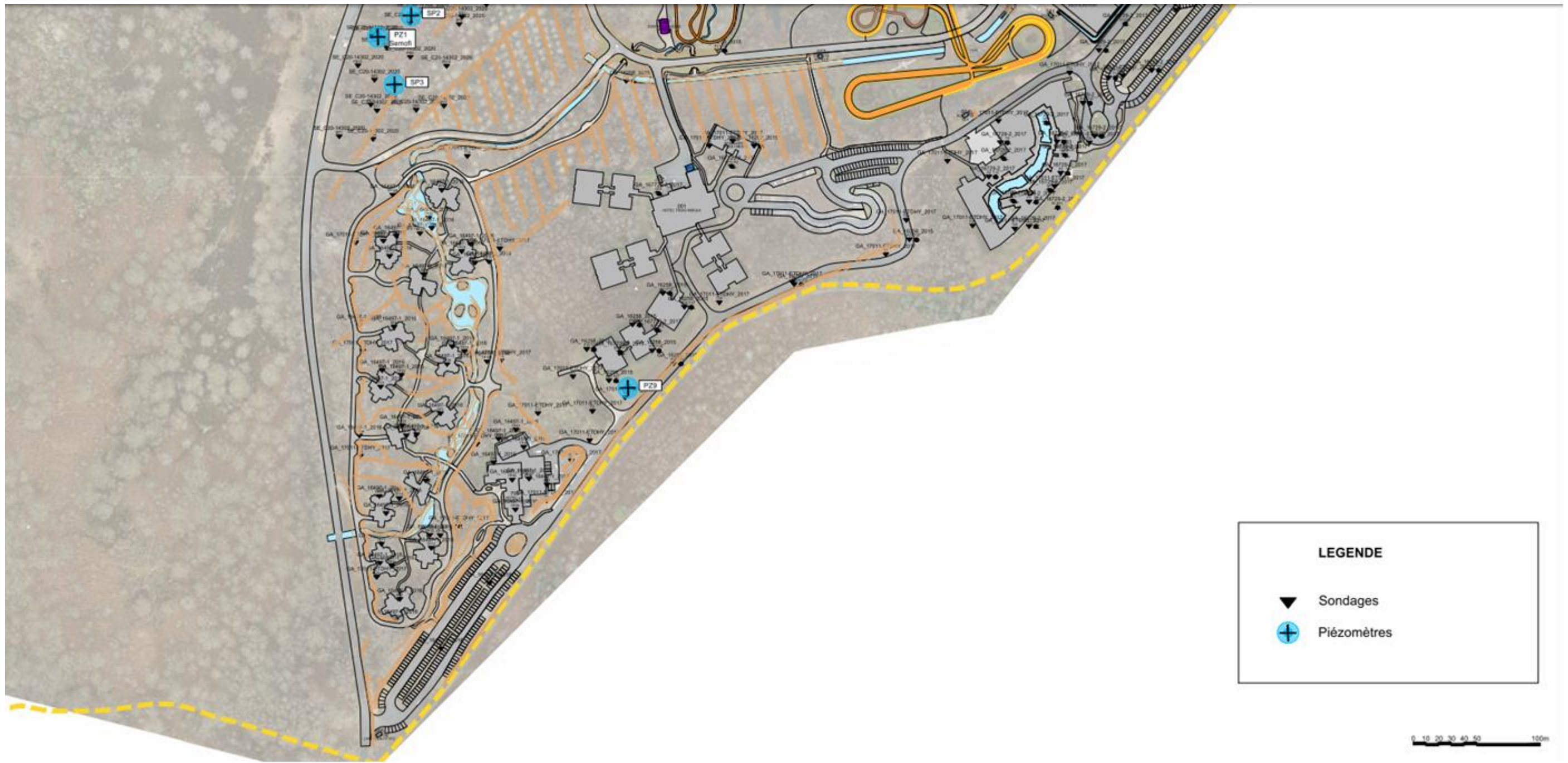
Figure 537 : Localisation des différents sondages géotechniques réalisés historiquement sur le parc – Planche 3 (Parc Astérix)
