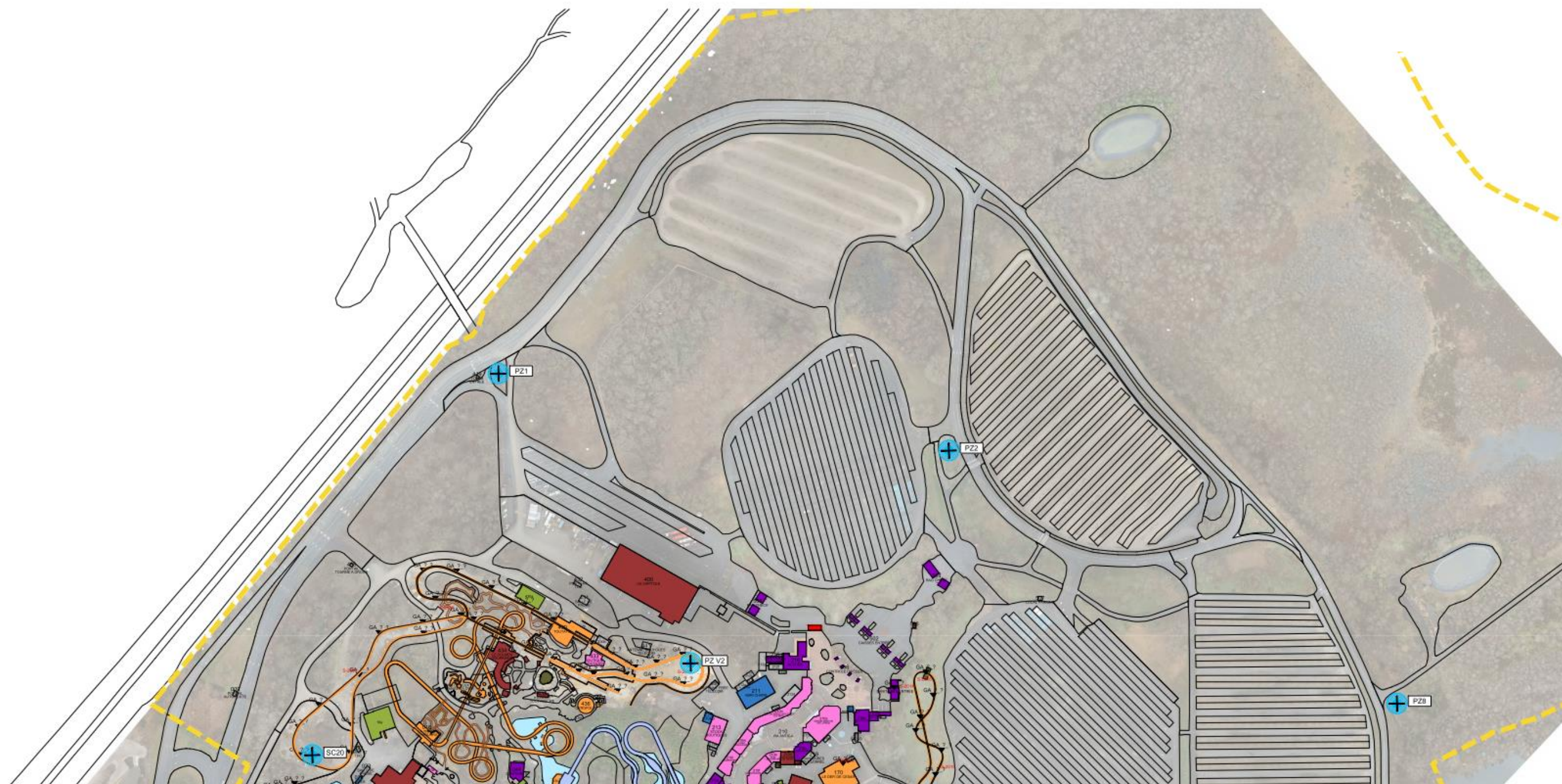
Figure 535 : Localisation des différents sondages géotechniques réalisés historiquement sur le parc – Planche 1 (Parc Astérix)
